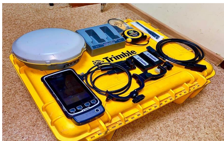
1.3- сурет – Зерттеу алаңында қолданылған GNSS Trimble R10
